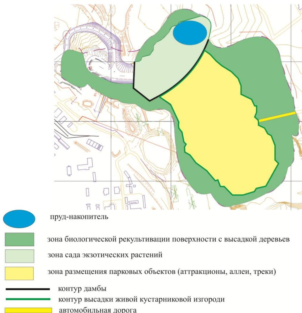
Рис.2 - Расположение зон различного назначения на территории рекультивированной провальной воронки
